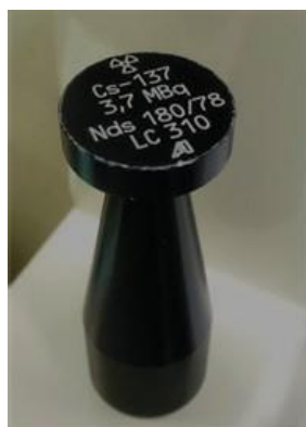
Figura 16. Sursă de referință de Cs-137 care se folosește la majoritatea calibratoarelor cu cameră de ionizare. În dreapta, este prezentat un rezultat al verificării de stabilitate.
