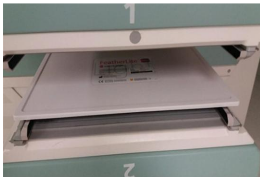
Figura 2. Verificare uniformității extrinseci utilizând ^{57}\text{Co}
